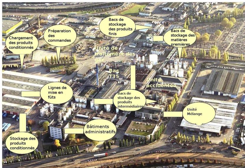
Fig. 2 : Principales installations de l'usine (exploitant)
